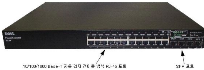
그림 2-1. 24개의 10/100/1000 Base-T 포트가 있는 PowerConnect 6224
